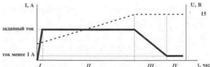
*Временные интервалы этапов работы: I - подключение, установка зарядного тока; II - процесс заряда; III - завершающая стадия заряда; IV - буферный режим*
