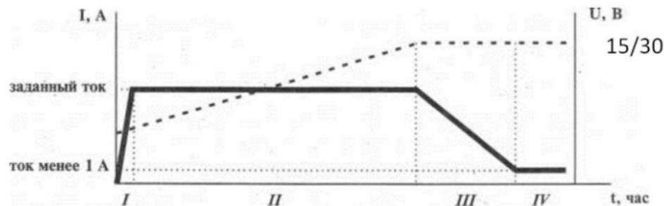
7. По окончании заряда отключить зарядное устройство от сети и отключить зажимы. Рекомендуется протереть зажимы и провода влажной, а затем сухой ветошью для удаления попавшего электролита. Желательно после этого смазать зажимы любой автосмазкой для защиты от коррозии.
